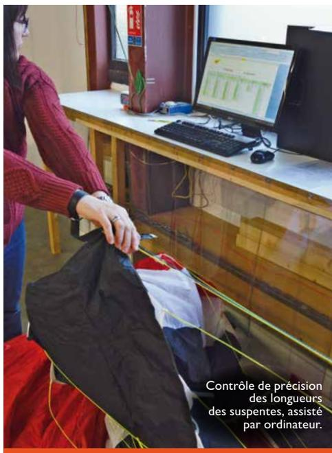
Contrôle de précision des longueurs des suspentes, assisté par ordinateur.
